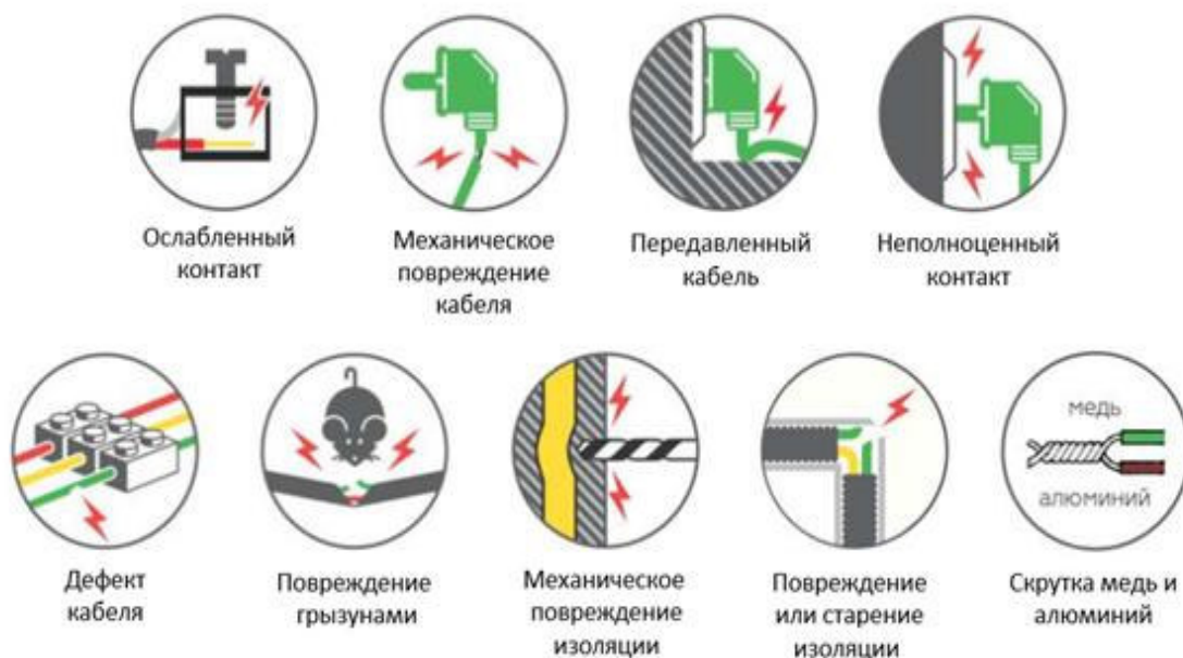
Рисунок 6. Возможные причины искрения в электропроводке
