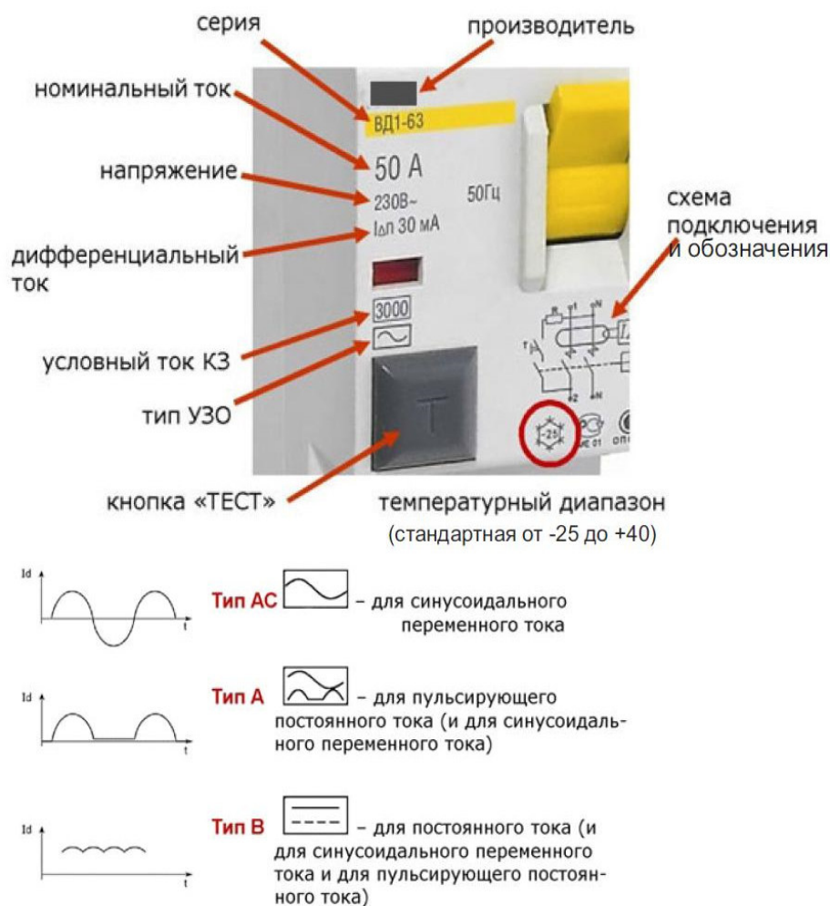
Рисунок 5. Маркировка УДТ
