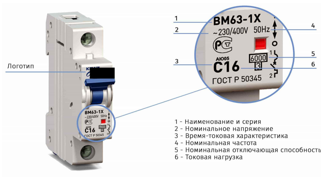
Рисунок 2. Пример маркировки АВ
